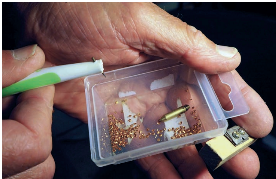
Knut Gransæthers verktøy for å masseprodusere 12–1300 bittesmå stoppskiver: En gramfonstift. Foto: Bjarne Røsjø
